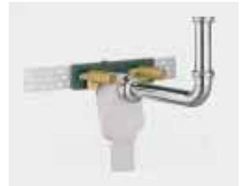
Anschluß-Einheit zu kombinieren. Zum Lieferumfang gehören ein Wandeinbau-Siphon 1 1/4" x 50, eine schallgedämmte Montageplatte, zwei MS-Wandscheiben sowie eine Leifeld-Lochschiene. Die Montageplatte wurde so konstruiert, daß auch andere handelsübliche Wandscheiben montiert werden können.
