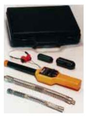
Rohr eingeführt wird und dann Signale an einen Handempfänger sendet. Mit diesem folgt man oberirdisch dem Rohrverlauf. Bei Ortung der Verstopfungsstelle wird ihre Tiefe angezeigt. Die Sonden sind in vier Größen lieferbar und werden zum leichteren Einführen oder Entfernen an Glasfaser- und normalen Rohrreinigungsstangen oder Hochdruck-Wasserspülschläuchen befestigt. Sie sind auch in Verbindung mit Minikamera-Inspektionsgeräten benutzhar
