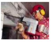
rial und Anforderung, auch während der Arbeit, funktionssicherer Leerschlagdämpfung, robuster Werkzeugaufnahme mit perfekter Staubabdichtung, Sicherheits-Schnellverschluß für schnellen Werkzeugwechsel sowie elektronischer Absenkung der Leerlauf-Schlagzahl für präzises Anmeißeln usw. Ein geschlossener Schmiermittelkreislauf macht das Gerät nahezu wartungsfrei.
