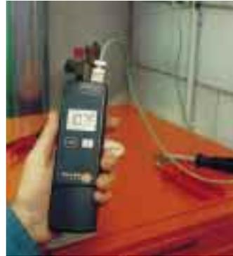
Handwerk und Industrie. Die Tastatur besitzt eine echte Bedienrückmeldung, so daß sie auch mit Handschuhen bedient werden kann. Das Display mit 14 mm Ziffernhöhe ist besonders beim Ablesen unter schlechten Lichtverhältnissen vorteilhaft. Der Meßbereich des Gerätes reicht von -60 bis +1000 °C. Eine große Fühlerpalette steht zur Verfügung.
