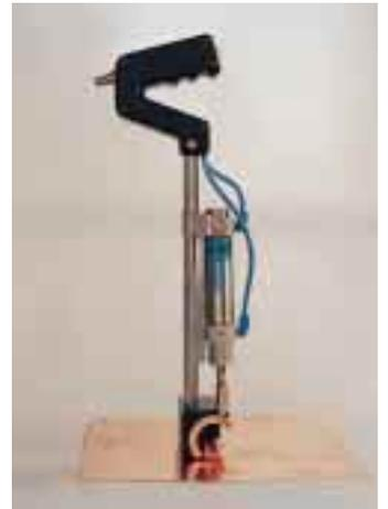
aus hochwertigen Materialien und ist rostfrei. Der Betriebsdruck muß min. 6 bar und kann nach verwendetem Material bis max. 10 bar betragen.
