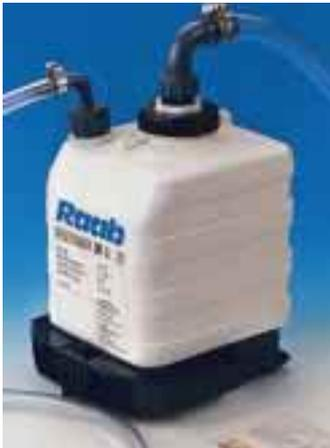
pH-Wert zwischen 2 und 4 aufweisen. Da dieser laut ATV-Merkblatt M 251 den Wert von 6,5 beim Einleiten ins öffentliche Kanalnetz nicht unterschreiten darf, muß das Kondenswasser von Heizungsanlagen über 25 kW in der Regel neutralisiert werden. Alternativ stehen hierfür die beiden Neutraboxen zur
