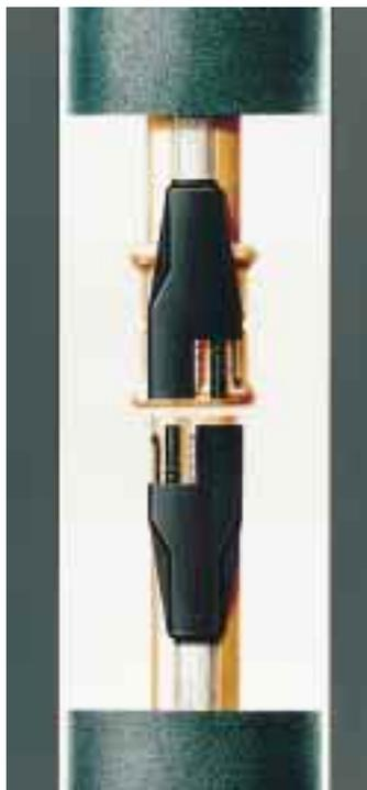
Das neue HWAT-Plus Modular vereint die Vorteile der selbstregelnden Temperaturhaltung mit denen der Registerbauweise. Für den Einsatz in Sanitärregistern stehen Temperaturhalteband-Module in den Längen 3,1 und 3,7 Meter zur Auswahl. Jedes Band wird mit Steckverbindungen geliefert, die bei der Installation vor Ort ineinander gesteckt werden, wodurch sich die Installationszeit um mehr als 20 % verkürzt.
