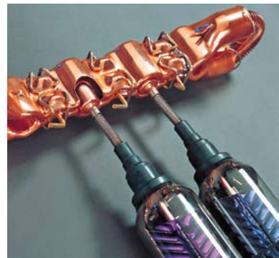
Bild 2 Die trockene Anbindung der Heatpipe-Röhren (im Bild Vitosol 300-T) und eine mechanische Temperaturbegrenzung bieten eine besonders hohe Betriebssicherheit
