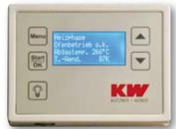
Am Display der Ofensteuerung kann stets das aktuelle Abbrandverhalten der Feuerstätte abgelesen werden
