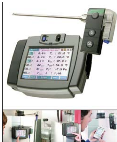
Mittels Bluetooth-Schnittstellen kann die Funkmesssonde des A 600 direkt vom Notebook oder Pocket-PC aus gestartet werden
