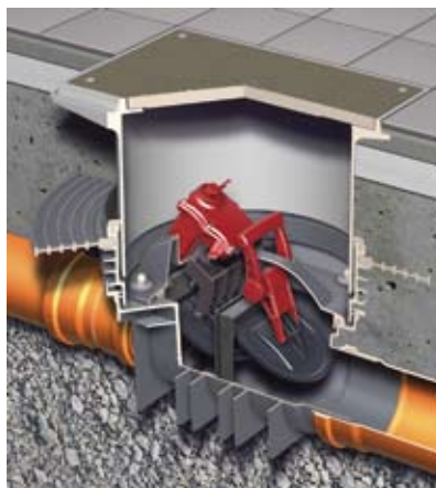
Ein nur geringer Versatz zwischen Zu- und Ablauf erleichtert den nachträglichen Einbau des Rückstauverschlusses
