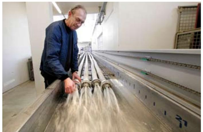
Die Schlauchreinigungsanlage „schluckte“ bislang reichlich Trinkwasser. Seit Januar 2007 wird sie mit Grau- und Regenwasser betrieben
