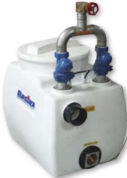
Die Hebeanlage „Tece-Basikalift OF-Mono/Duo“ wurde für die Aufstellung hinter allen Basika-Fettabscheidern der Nenngrößen NG 1 bis 7 konzipiert. Sie besteht aus einem Kunststoffbehälter, zwei Tauchmotorpumpen mit einem Hosenrohr und Druckleitungen aus Edelstahl (V4A) sowie aus einer elektronischen Steueranlage. Der
