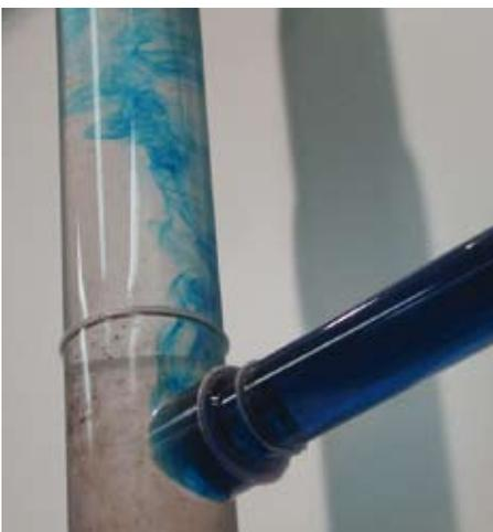
**Bild 2** Visualisierte Ausschwemmung des eingefärbten Wassers aus einer Totleitung in die Steigleitung
