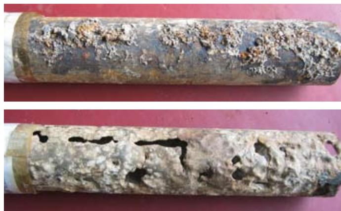
**Bild 19** Korrosion durch inhomogene Bettung: oben in Kies gebettete, unten in Lehm gebettete Rohrhälfte
