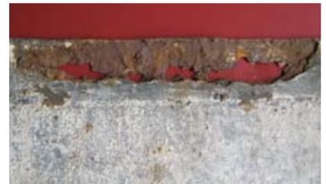
**Bild 18** Korrosion an erdverlegtem Stahlblech durch unterlegte Holzkeile
