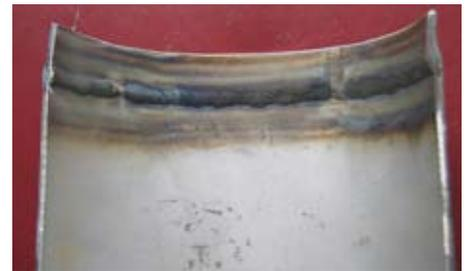
**Bild 12** Nicht nachbehandelte Schweißnaht mit Anlauffarben
