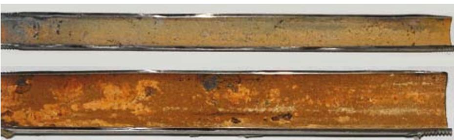
**Bild 22:** Einfluss der Fließgeschwindigkeit auf die Innenkorrosion von verzinkten Wasserleitungen:
