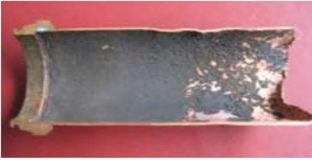
**Bild 4** Deckschichten aus Kupfer: links, braune bis schwarze Deckschicht aus Kupferoxid. Rechts, grüne Deckschicht aus basischem Kupfercarbonat
