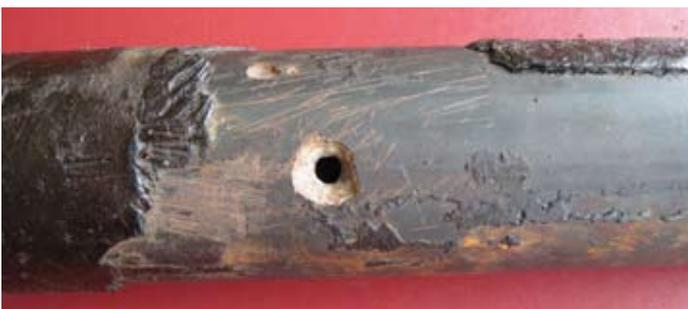
**Bild 25** Typischer kraterförmiger Korrosionsangriff an erdverlegter Stahlleitung infolge Einwirkung von Gleichströmen
