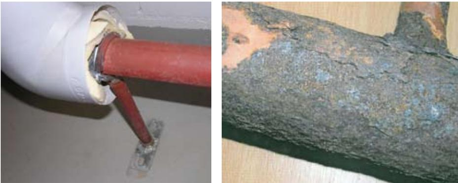
**Bild 24** Außenkorrosion an einer Heizungsleitung, verursacht durch Salzsäureabspaltung aus Chlorkautschukbeschriftung (v. l.): nicht isolierter Bereich der Rücklaufleitung (unkritische Temperaturen, keine Schäden), Angriffe in isoliertem Bereich der Vorlaufleitung
