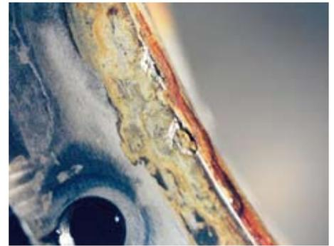
**Bild 11** Spaltkorrosion bei Flanschverbindungen
