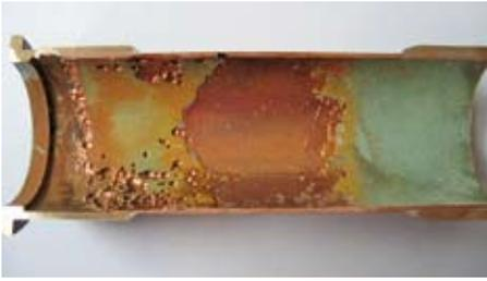
**Bild 15** Unsachgemäße Verarbeitung von Kupferrohren, Verminderung der Korrosionsbeständigkeit durch Lot- und Flussmittelrückstände
