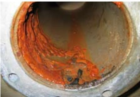
**Bild 9** Innenkorrosion an einer verzinkten Stahlleitung im Übergangsbereich zu einem Filterkorb aus nichtrostendem Stahl
