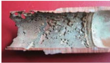
**Bild 20** Schäden an Kupferrohren infolge zu hoher Fließgeschwindigkeiten (v.l.): Erosion an Fitting, Abtrag der schützenden Deckschicht mit anschließender Korrosion
