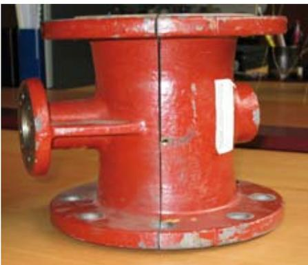
**Bild 10** Perforation an einer in einer Trinkwasserleitung aus nichtrostendem Stahl eingebauten Gussarmatur mit kleinflächig verletzter Innenbeschichtung nach fünf Jahren Einsatzdauer
