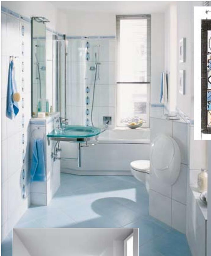
**Beispiel 2** Mit dem als Wandsäule verkleideten wandparallelen Element wird der Waschtisch hervorgehoben, die kombinierte Diagonalmontage von Urinal und WC sorgt dafür, dass zwei separate Funktionsbereiche entstehen
