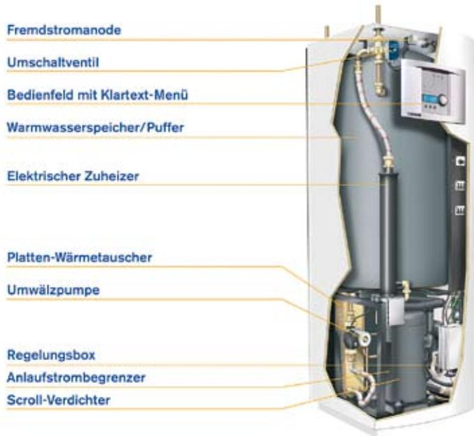
**Bild 6** Aufbau einer Sole/Wasser-Wärmepumpe aus der Junkers-TM-Serie (Heizleistung: 10,9 kW bei 5 °C/W 35 °C; COP: 5,0). Im Bedarfsfall erhöht ein elektrischer Zuheizler die maximale Heizleistung um 9 kW. Im Gehäuse integriert sind ein 163-l-WW-Speicher sowie ein Heizwasser-Puffer mit 57 l
