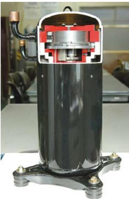
Bild 4 Scroll-Kompressoren sind deutlich leiser als Hubkolben-Kompressoren
