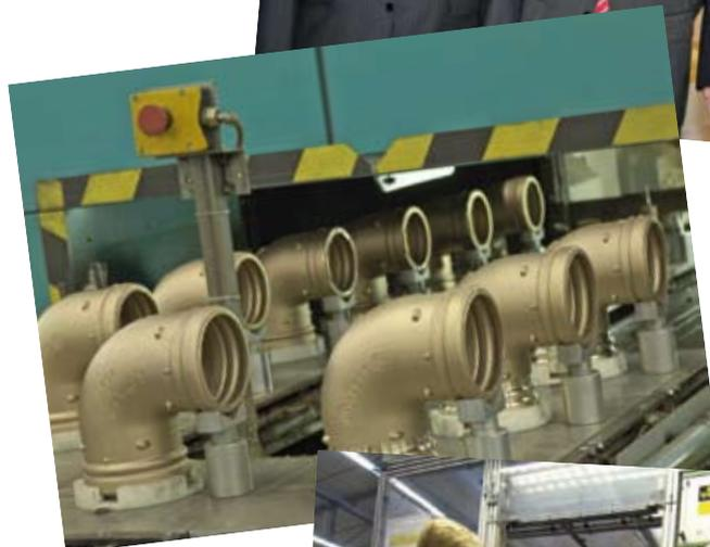
In den automatisierten Zerspanungsmaschinen werden die Innen- und Außenkonturen der Pressverbinder eingedreht
