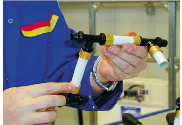
◀ Mit Handpresszange verbunden: Mehrschichtverbundrohr mit Pressfitting
