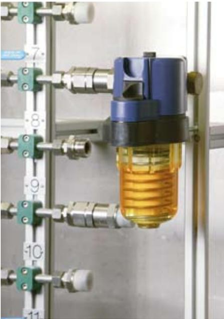
Der Drufi im Dauertest, angeschlossen am Lastwechsel-Prüfstand.
