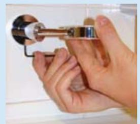
Accessoire auf das Klebepad setzen und die Madenschraube anziehen
