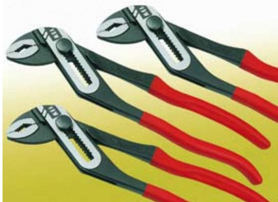
Die beiden neuen Wasserpumpenzangen Fast-Grip und All-Grip des Remscheider Werkzeugspezialisten VBW wurden speziell für Einsätze im SHK-Bereich entwickelt. Der Unterschied zwischen beiden Zangen liegt im Einstellungssystem und in der Feinverstellung. Bei Fast-Grip wird die richtige Maulweite per Druckknopf direkt am Werk-
