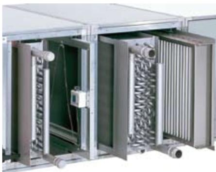
Die Bauweise der neuen Klimagerätebaureihe KG/KGW-Top von Wolf folgt weitgehend den Vorgaben der neuen VDI-Richtlinie zur hygienebewussten Planung, Ausführung und Instandhaltung raumluftechnischer Anlagen (VDI 6022). So wurde beispielsweise bei der Rahmenkonstruktion darauf geachtet, dass Böden und Deckel glatt und spaltenfrei sind. Die Abdichtung der Paneele gegenüber der Rahmenkonstruktion erfolgt durch geschlossensorige, desinfektionsmittel- und alterungsbeständige Kunststoffleisten. Kompo-
