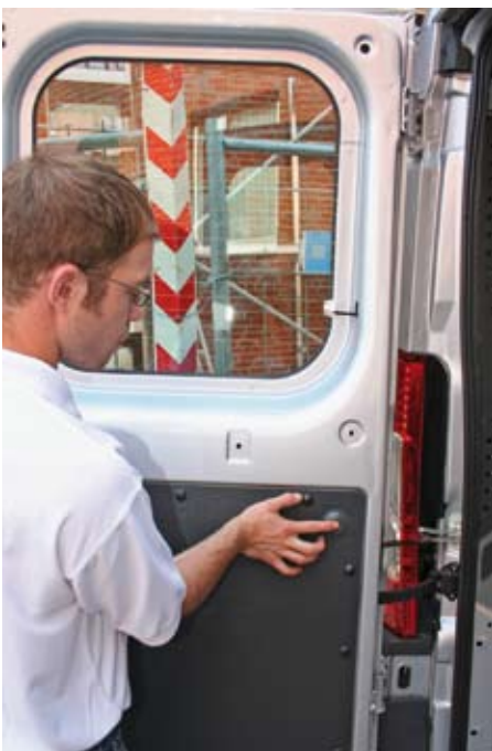
Praktisches Detail: An der Hecktür lässt sich die 90-Grad-Arretierung per Knopfdruck überwinden
