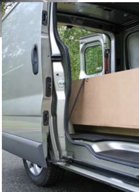
Nicht sicher: Die Türaste kann bei Gefälle versagen. Im Frachtraum mangelt es in der Basisausstattung an Verkleidungen
