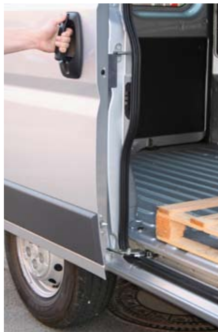
Sicher gemacht: Bei Gefälle kann die Frachtraumtür nicht zufallen, weil sie erst entriegelt werden muss
