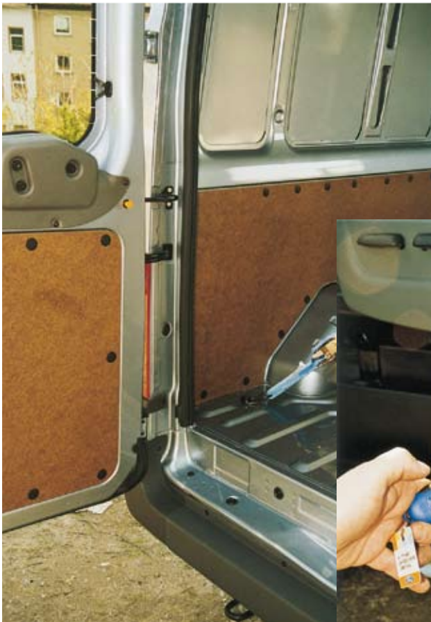
Mangelware im Frachtraum: Die niedrigen Pappverkleidungen (Standard) vermögen die Seitenflächen kaum zu schützen
