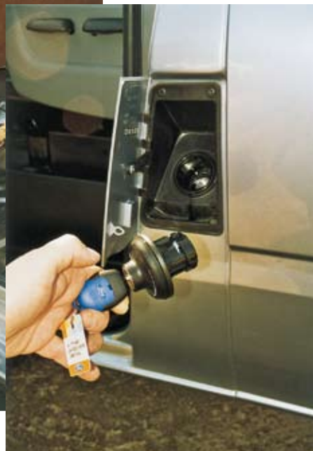
Unkomfortabel: Weder Schnur noch Steckvorrichtung ist vorhanden, um den Tankverschluss kurzzeitig loszuwerden
