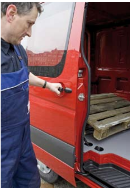
Sicher: Nur per Tastendruck (außen oder innen) lässt sich die geöffnete Seitentür entriegeln. Der Einstieg ist solide gemacht
