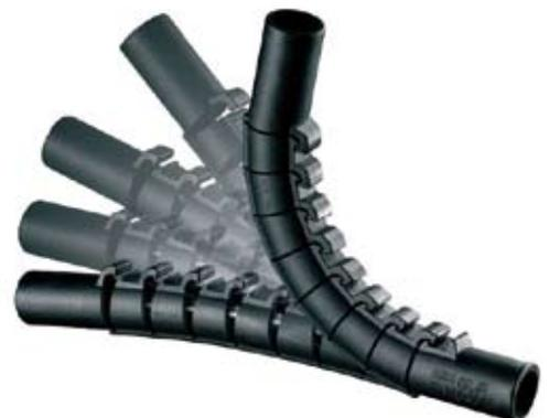
dung an Heizkreisverteiler und Heizkörper, bei der Verlegung von Flächenheiz- und -kühlsystemen in der Rohbaukonstruktion, im Bereich von Estrichdurchdringungen und Aussparungskanten. Der Rohrführungsbogen eignet sich für alle Kunststoffrohre mit 15 bis 17 mm sowie 20 und 28 mm Außendurchmesser. Die Bogenradien lassen sich flexibel bis max. 90° einstellen. Bei Bedarf können die Rasterhaken mit einem Schraubenzieher wieder geöffnet werden.
