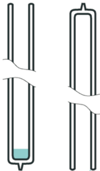
Bild 4 Ein Vorteil der nach unten geöffneten Röhren: das Kondensat läuft einfach ab und kann die Röhre nicht durch Gefrieren sprengen
