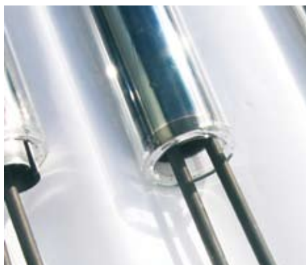
Bild 7 CuNi-Verrohrung nach zwei Monaten Stagnation ohne Verzunderung
