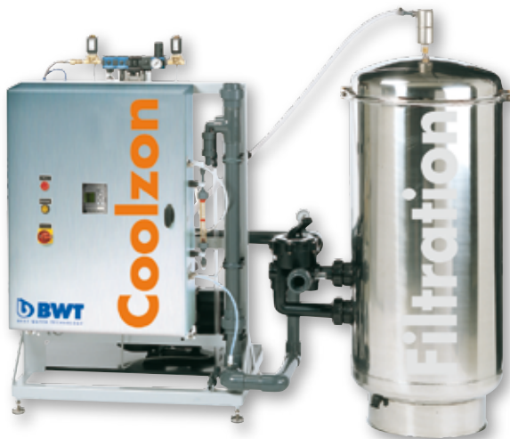
Bild 3 Coolzon-Ozonanlagen desinifizieren Kühlwasser/Luftbefeuchterwasser und bauen zugleich den Biofilm ab
