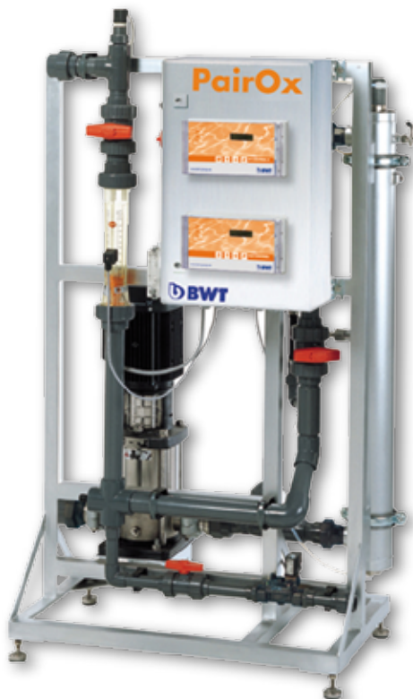
Bild 4 Beim PairOx-Verfahren wird das zirkulierende Befeuchtungswasser von RLT-Anlagen mittels UV-Bestrahlung und Ozon-Eintrag desinifiziert
