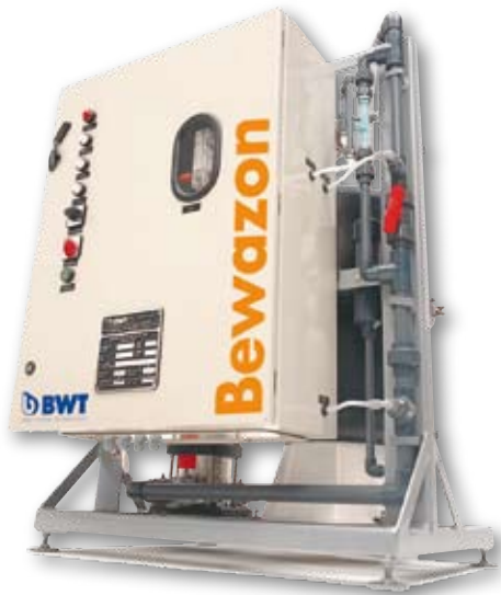
Bild 5 Ozon oxidiert organische und anorganische Wasserinhaltsstoffe, daneben werden Krankheitserreger abgetötet und Viren inaktiviert – zur Aufbereitung von Schwimmbadwasser eignen sich Ozonanlagen besonders
