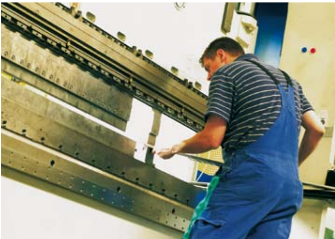
Duschrinnen-Produktion: Abkanten der Edelstahl-Profilbleche
