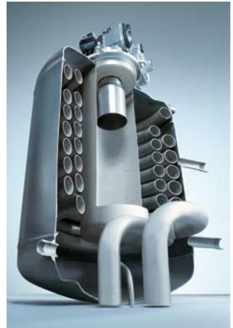
Beim Öl-Brennwertkessel „Icovit“ strömt das Abgas aus der Brennkammer in zwei, je ca. 9 m lange Rohrschlangen und wird im Gegenstromprinzip quasi auf Rücklauftemperatur abgekühlt
