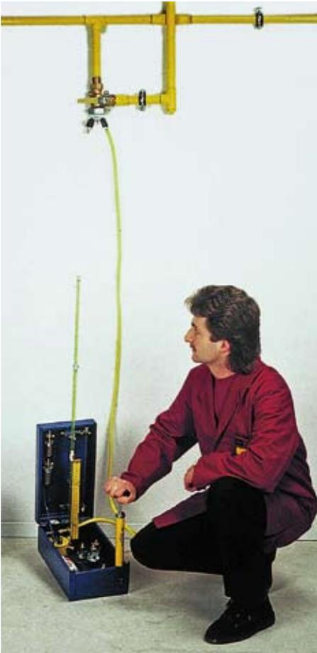
Ein geeignetes Messgerät zur Ausführung einer Hauptprüfung ist das U-Rohr-Manometer
