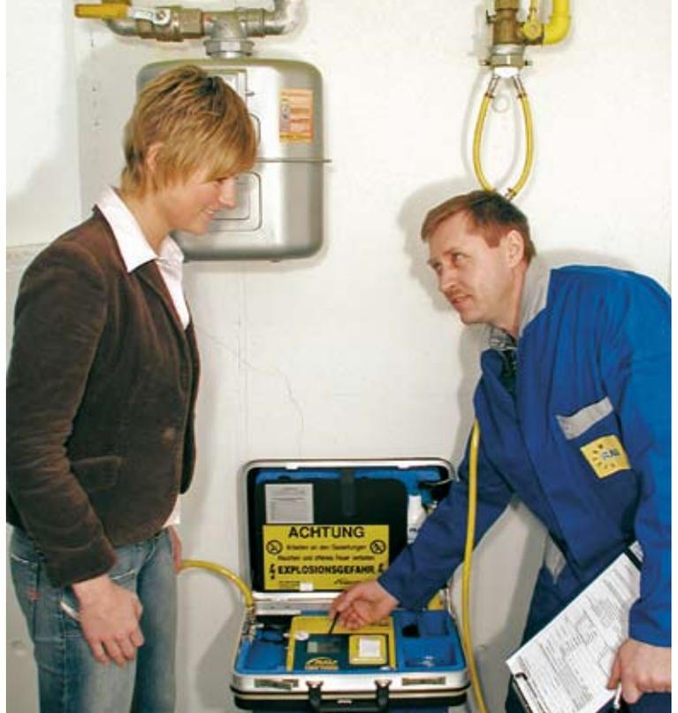
Mit Hilfe von elektronischen Leckmengenmessgeräten lassen sich selbst geringste Leckagen genau und volumunenabhängig erfassen
