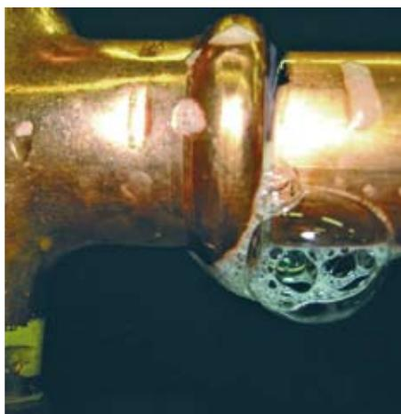
Werden zur Schlussprüfung schaubildende Mittel eingesetzt, signalisiert eine Blasenbildung das Leck
