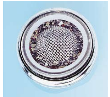
Bild 4 Fremdpartikel in der Hausinstallation setzen sich fest, beschädigen Dichtungen und verstopfen Perlatoren
