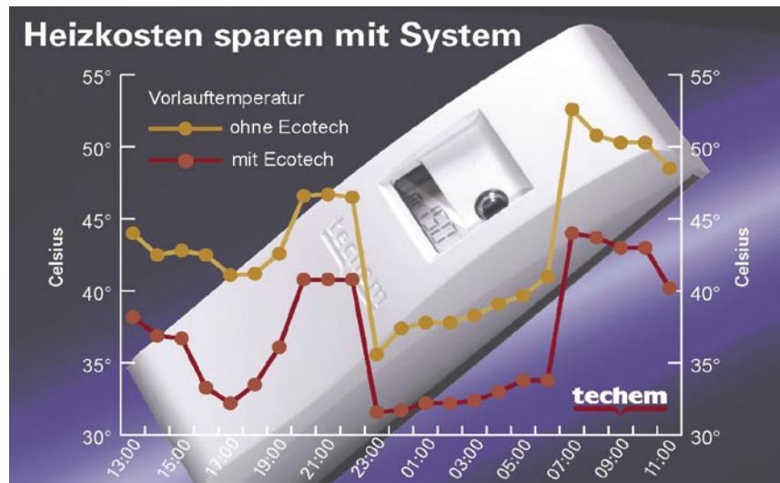
Das neue Ecotech-System soll die Vorlauftemperatur in der Heizungsanlage so senken, dass es in den Räumen nicht kälter wird (Vergleich in zwei Gebäuden)
