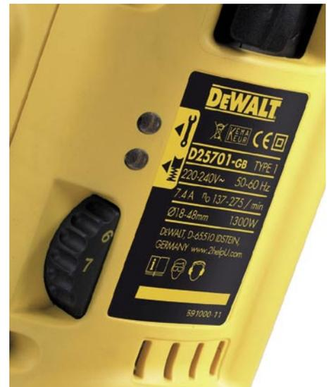
Das Rändelrad ermöglicht die materialgerechte Einstellung von Dreh- und Schlagzahl
