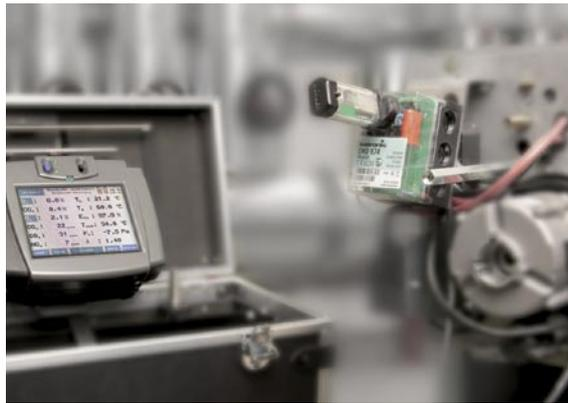
Brenners erfassen und analysieren. Auch geloggte Fehlerprotokolle der Steuerung lassen sich somit nachvollziehen.
