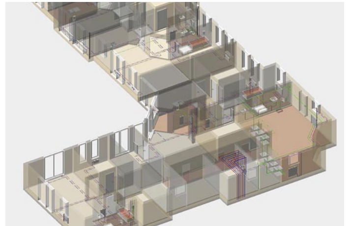
◀ Transparente Schnittdarstellung eines EFH über alle Etagen. Zur Ausstattung gehört hier – neben Heizung und Sanitär – auch eine kontrollierte Wohnungslüftung
