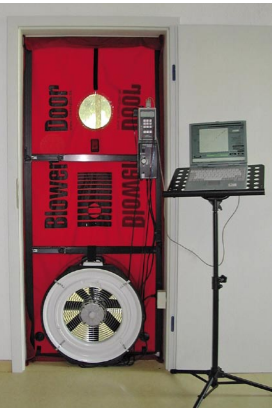
...deshalb wurde anschließend mit der Blowerdoor überprüft, ob die Wände und Decken der beiden Gauben in der Praxis Undichtigkeiten aufweisen
