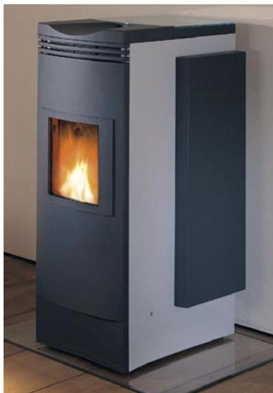
Unter der Bezeichnung Fire-WIN hat Windhager eine Pellet-Wärmezentrale für das Wohnzimmer vorgestellt. Sie ist in vier Stil- und Farbkombinationen sowie in zwei Gerätegrößen im Nennwärme-Leistungsbereich von 2,9 bis 12 kW verfügbar. Besondere Konstruktionsmerkmale sorgen für lange Reinigungs- und Betreuungsintervalle. So wird z. B. die Asche vollautomatisch in einen integrierten Behälter geleitet, der die Verbrennungsrückstände mehrerer Monate aufnehmen kann. Die vollautomatische Brennerschalen-
