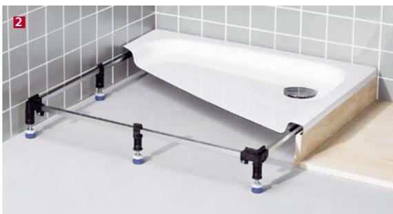
ßen 90 x 90 und 120 x 120 cm für normale sowie 150 x 170 cm für XXL-Formate erhältlich. Im Unterschied zu herkömmlichen Fuß-Rahmen deckt der FR 5300 mit diesen drei Abmessungen das komplette Größensortiment ab. Ein Fuß-Rahmen wird aus je vier Alu-Vierkantrohren, vier Eckverbindungsstücken mit Fuß, vier Füßen zur Mittenabstützung der Vierkantrohre sowie Gummiprofilen zur Schallsisolierung zusammengesetzt.
