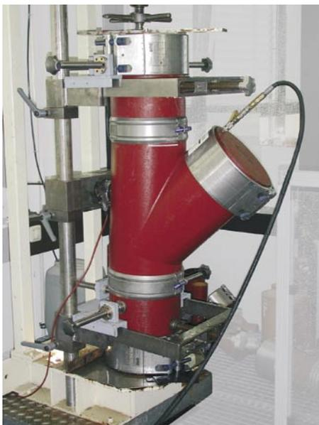
**Bild 1** Wasserdichtheitsprüfung unter Innendruck bei Abwinklung und Scherlast
