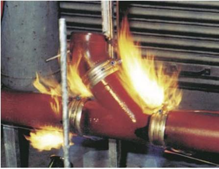
Bild 3 Flammprüfung über 90 Minuten des lose gelagerten Prüfstranges
