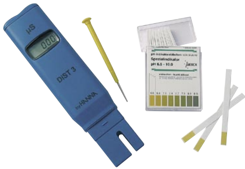
Bild 7 Die Wasserhärte (Gesamthärte) kann mittels einer Leitfähigkeitsmessung zwar grob geschätzt werden, es empfiehlt sich aber der Einsatz von derartigen Tests
