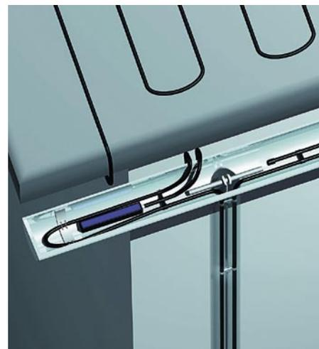
die Heizleiter durch eine Steuerung, die über einen Feuchtefühler und einen Temperatursensor verfügt. Aus den erfassten Daten ermittelt die Steuerung den jeweiligen Einschaltzeitpunkt, um die Eisbildung knapp vor dem Gefrierpunkt zu verhindern.
