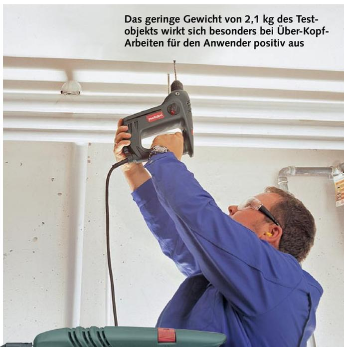
Das geringe Gewicht von 2,1 kg des Testobjekts wirkt sich besonders bei Über-Kopf-Arbeiten für den Anwender positiv aus
