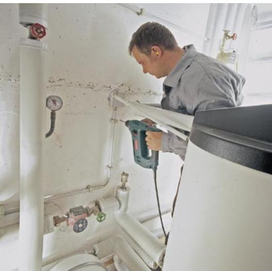
**Mit einer Einzelschlagenergie von 1,6 Joule bohrt der „BHE 20 Compact“ Löcher von 6–20 mm in Beton**
