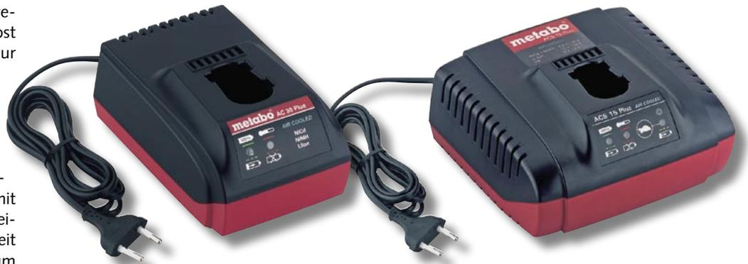
**Moderne Ladegeräte sind für Li-Ion-, NiCd- und NiMH-Akkupacks mit Spannungen zwischen 4,8 V und 18 V konzipiert. Sie erkennen Art und Spannung des Akkupacks und stellen den Ladevorgang automatisch darauf ein**
