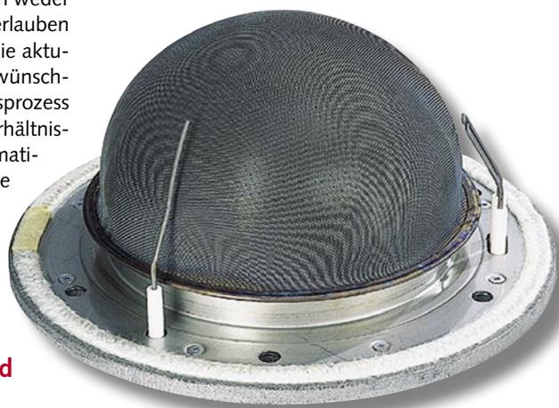
Bild 5 Matrix-Gasbrenner mit der Ionisationselektrode (vorne links) zur Messwertfassung für die „Lambda Pro Control“-Verbrennungsregelung (rechts sitzt die Zündelektrode)
