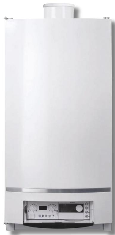
**Kompaktes Gas-Brennwertgerät mit 100 kW: der Logamax plus GB162 ist so breit wie ein 24-kW-Kessel und wiegt nur 70 kg; sein Keramikbrenner arbeitet modulierend im Bereich 19 bis 100 %**
