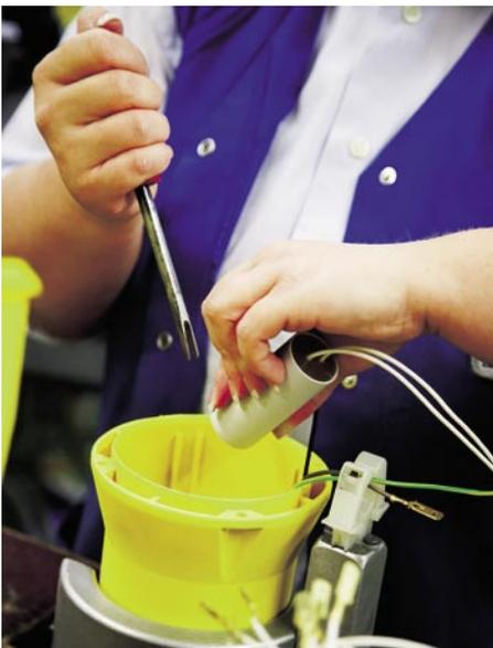
In die vorbereitete Abdeckung wird von Hand der Kondensator eingesetzt
