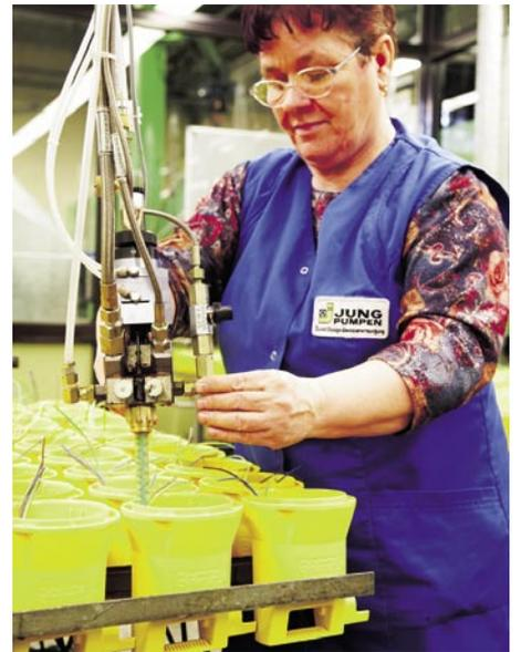
Durch die Isolation an der Leitungseinführung werden die Pumpen wasserdicht
