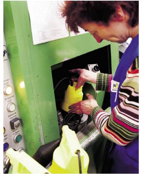
Im abschließenden Test wird die Geräusentwicklung während des Betriebs überprüft
