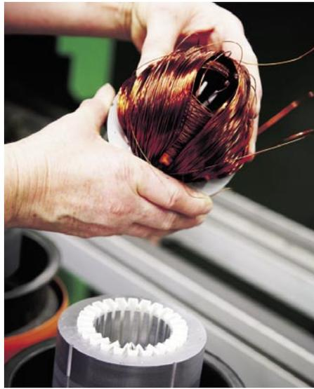
Große Fertigungstiefe: Die Spule ist das Herzstück des späteren Pumpenmotors
