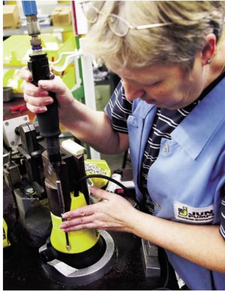
Endmontage aus Pumpenmotor, Hydraulik, Abdeckung und Schwimmerschalter
