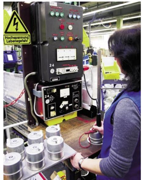
Eine erneute Spannungsprüfung testet die komplette Antriebseinheit
