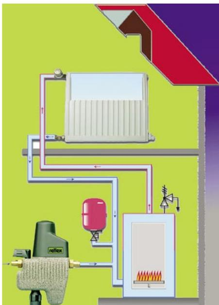
**Bild 5** Einbau des Nachspeisesystems „Fillcontrol“ in die Heizungsanlage
