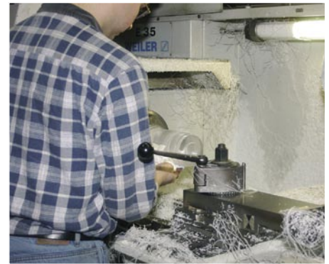
An der Drehbank entsteht das Gehäuse für eine Filtertasse
