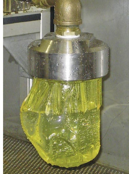
Die Filtertasse hielt beim Drucktest 99 bar aus
