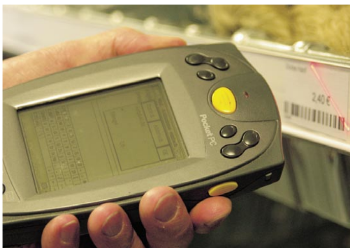
Mit einem Barcode-Laser-Scanner werden im Lager die Zu- und Abbuchungen erfasst und das Material den entsprechenden Baustellen zugeordnet
