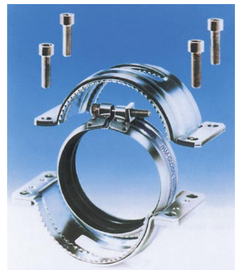
Bild 10 PAM-Global Rapid-Verbindung mit Rekord-Kralle DN 40 bis 100 bei Innendruckbelastung bis zu 10 bar
