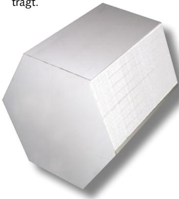
Wirkungsweise: Beim Enthalpie-Wärmetauscher kondensiert Dampf aus der feuchten Abluft an der kühleren Oberfläche der Membran. Die Wassermoleküle wandern durch die Membran von der Abluft- zur Zuluftseite. Auf der Außenluftseite verdampft das Wasser an der Membranoberfläche und wird so an den trockeneren Zuluftstrom abgegeben.
