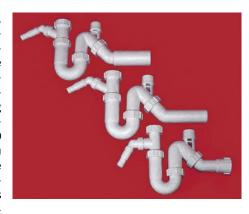
terdruck im Leitungssystem öffnen die Belüfter und lassen Luft einströmen bis ein Druckausgleich hergestellt ist, dann schließen sie wieder. Bei Überdruck bleiben sie durch entsprechende Membrankonstruktion luft-, geruchs- und wasserdicht. Es gibt sie in verschiedenen Ausführungen von Ø 32 mm bis Ø 110 mm, als Rohrbelüfter, Leitungsbelüfter sowie Röhrensifone mit integriertem Belüftungsventil. *McAlpine*, 61137 Schöneck
