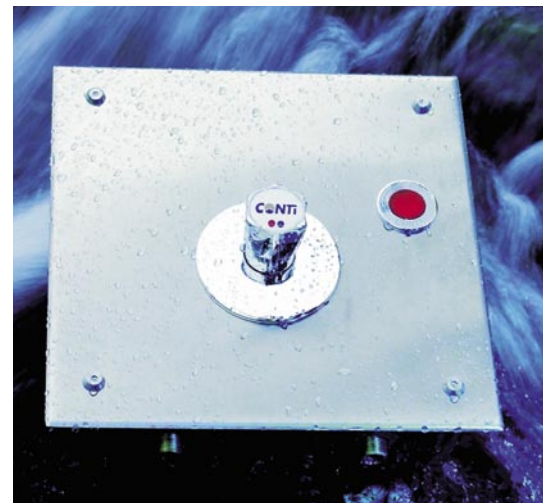
Mit der Conbus-EIB werden Sanitärarmaturen in die Gebäudeleittechnik integriert. Das ermöglicht die Automatisierung von Funktionsabläufen wie zeitabhängige Hygienespülung oder die überwachte thermische Desinfektion
