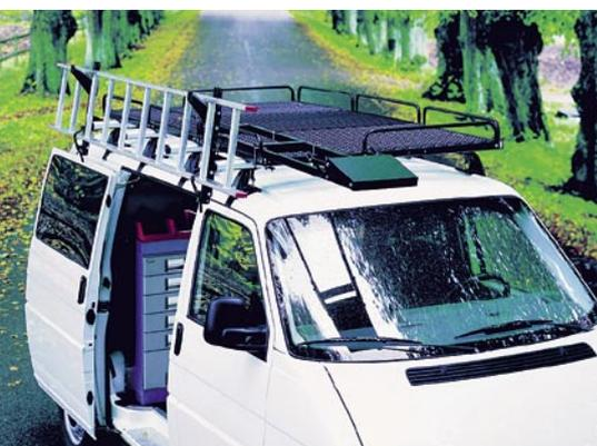
Das Dachträgersystem von Servicemobil erweitert z.B. mit Plattform sowie Fangschale fürs Langgut die Transportmöglichkeiten
