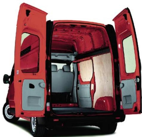
Dem Werterhalt des Transporters nützen vollflächige Sperrholzabdeckungen im Frachtraum. Sie lassen sich zudem mit Ankerschienen kombinieren
