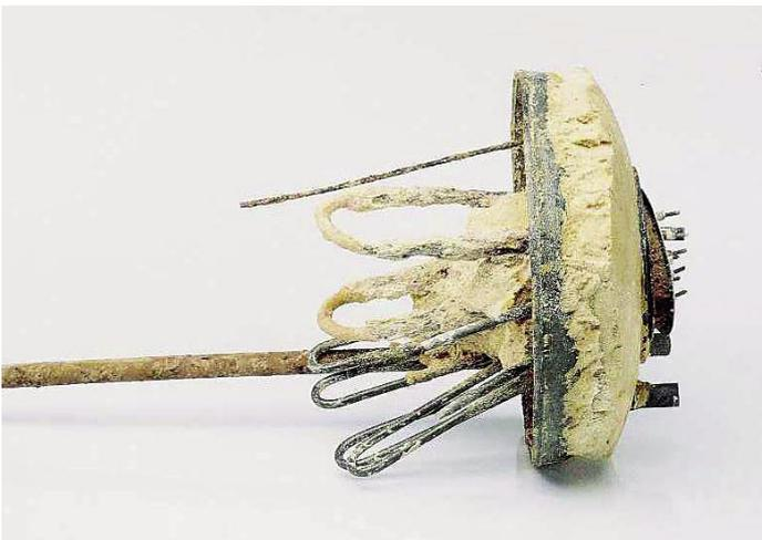
Kalk setzt sich in Rohrleitungen fest und zerstört Heizstäbe von Warmwasserbereitern
